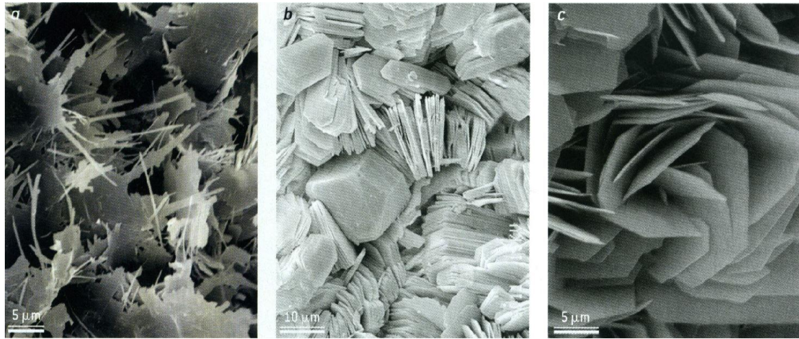
Fig. 6 : Particules d'argile vues au microscope électronique (Source : Van Damme, 2013 : p. 54)
